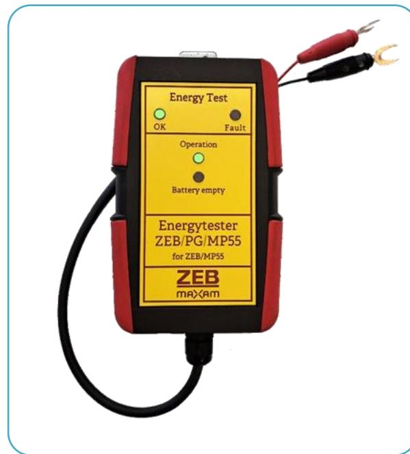
Unser ZEB/PG ist ein tragbares Energiemesssystem für Zündmaschinen. Beim Anschluss des /PG an die Ausgangsklemmen einer Zündmaschine, während kein Zündkreis angeschlossen ist, berechnet der ZEB/PG die Ausgangsenergie der Zündmaschine während des Auslösens eines Probeschusses.
